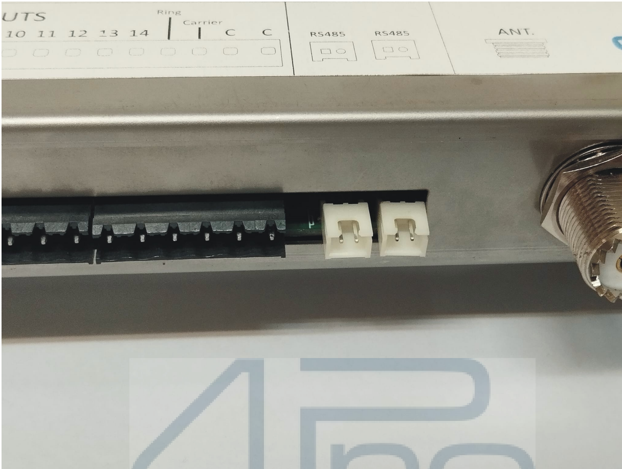
Figura 7: Puerto de comunicaciones 485
